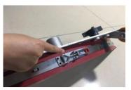
7. 使用多用途清洁剂和湿布擦试机器(图 24),为安全起见:清理机器时,请勿以高压喷洒或水管冲洗机器,这可能会导致电气系统故障。
